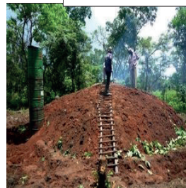
Utilisation de la Meule casamançaise pour améliorer l'efficacité énergétique de la production de charbon de bois
